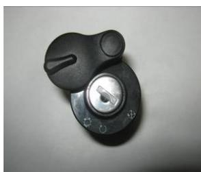
Рисунок 6 – Замок зажигания
