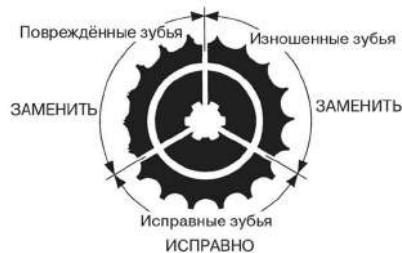
Рисунок 3. Износ звезд
