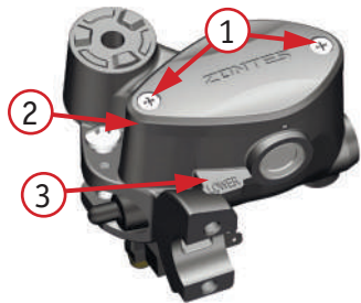
4.8.1. Бачок тормозной жидкости передних тормозов: 1 – винты крепления крышки бачка; 2 – крышка бачка; 3 – уровень «минимум»
