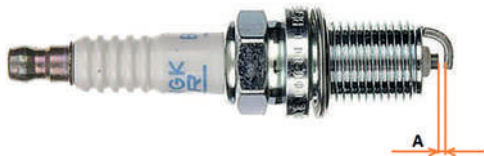
Фото 4.4. Зазор между электродами свечи зажигания
