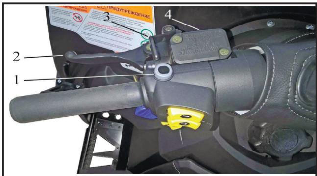
1. Кнопка остановки двигателя – «стоп - двигатель» (кнопка временно отключена). При нажатии на кнопку при работающем двигателе, зажигание выключается и двигатель глохнет, другие электроприборы продолжают работать в штатном режиме.
