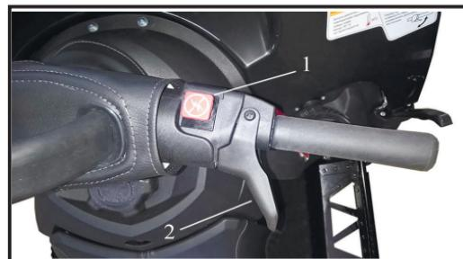
1. - кнопка экстренного выключения зажигания имеет два фиксированных положения. Нажатием на кнопку система зажигания выключается и двигатель выключается. Все электроприборы остаются под напряжением в рабочем состоянии. При переводе кнопки в верхнее положение состояние системы зажигания и электроприборов зависит от положения ключа в замке зажигания.
