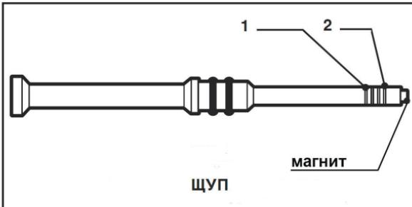
Коробка передач расположена в левой задней части подкапотного пространства. Для обеспечения доступа к ней следует поднять капот. Щуп проверки уровня масла в коробке передач конструктивно сделан неверно и показывает расхождения между фактическим уровнем масла в коробке и показаниями меток (1) и (2) на щупе, поэтому мы им не пользуемся.
