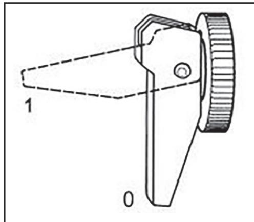
Для пуска холодного двигателя и в начальный период его работы, пока он не прогрет, требуется дополнительное обогащение топливной смеси, то есть увеличение доли бензина в ее составе.
