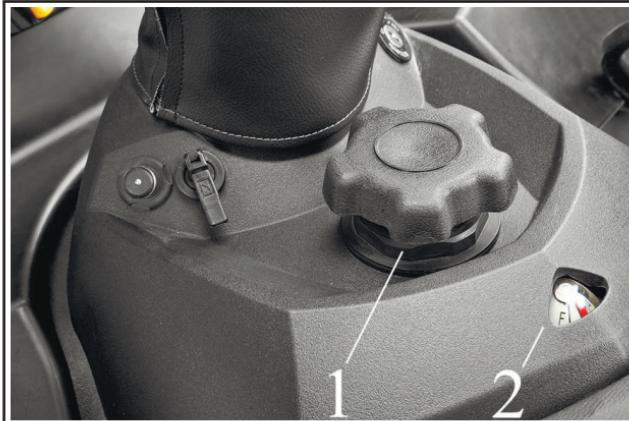
1. крышка топливного бака    2. указатель уровня топлива
