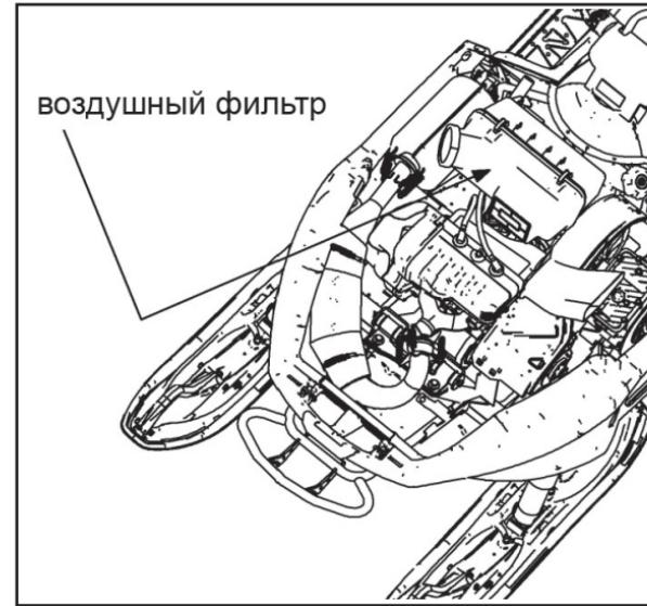
**ПРЕДОСТЕРЕЖЕНИЕ:** Регулярно проверяйте состояние фильтрующего элемента воздухофильтра. Наличие снега, льда или каких-либо загрязнений, препятствующих свободному прохождению воздуха через фильтрующий элемент, ведет к падению мощности двигателя и увеличению расхода топлива. Порванный фильтрующий элемент или его отсутствие влечет за собой ускоренный износ деталей двигателя и выход его из строя.
