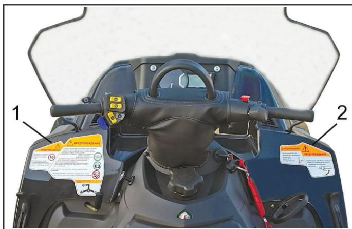
1 - основные требования безопасности при эксплуатации и схема переключения передач
