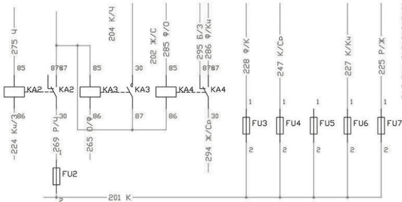
201-+12в после предохранителя F1
