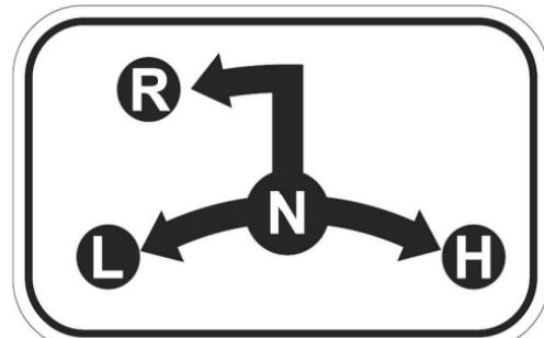
Схема переключения передач
