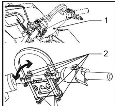
1. Снимите кожух рулевой колонки.
