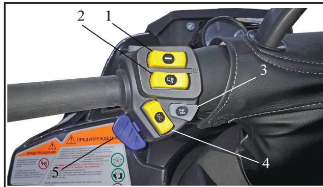
4. - клавиша включения фары головного света. При нажатии на правую или левую сторону клавиши до щелчка она фиксируется в утопленном состоянии, при этом включаются фары головного света в ранее установленный режим последнего включения фар (дальний или ближний) с помощью кнопки (5). Для выключения фар головного света переведите клавишу в среднее положение.
