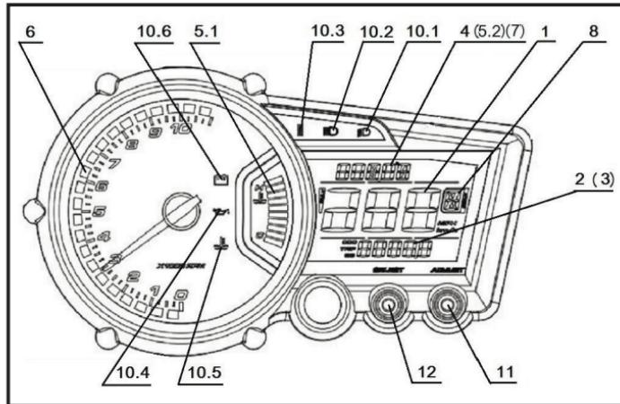
1. Спидометр. Показывает скорость движения снегохода. Доступна возможность выбора единиц измерения: км/час – миль/час.
