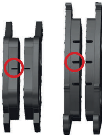
Фото 5.9. Определение износа тормозных колодок
