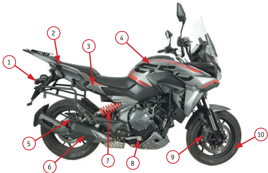
Фото 2.2. Вид справа: 1 - фонарь освещения номерного знака; 2 - задний подлокотник; 3 - фиксатор подушки сиденья; 4 - топливный бак; 5- задний тормозной суппорт; 6 - глушитель; 7 – задний амортизатор; 8 – рычаг заднего тормоза; 9 - правый передний тормозной суппорт; 10 - переднее колесо
