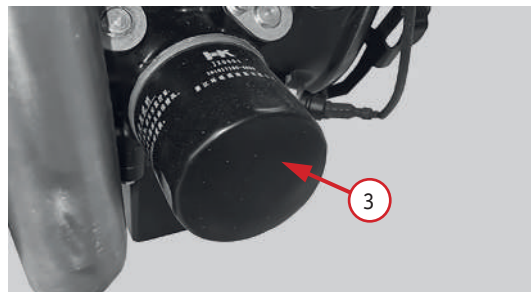
Фото 5.6. Замена масляного фильтра 3
