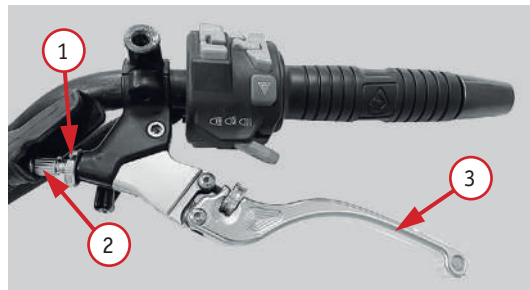
Фото 2.11. Регулировка сцепления: 1 – стопорная гайка; 2 – регулировочный винт; 3 – рычаг сцепления
