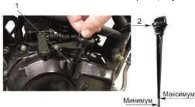
Рисунок 6 – Проверка уровня масла в двигателе
