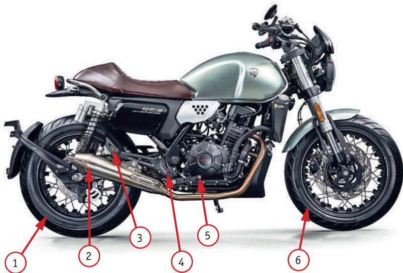
Фото 2.2. Вид справа: 1 – заднее колесо; 2 – глушитель; 3 – правая подножка пассажира; 4 – правая подножка водителя; 5 – педаль заднего тормоза; 6 – переднее колесо
