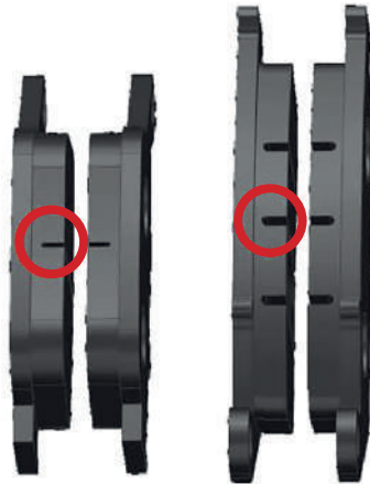
Фото 5.10. Определение износа тормозных колодок
