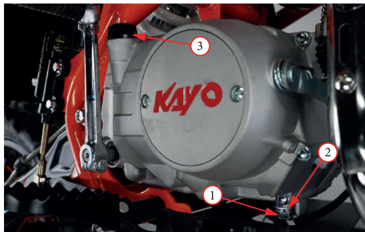
Фото 5.4. Замена масла в двигателях без фильтра
