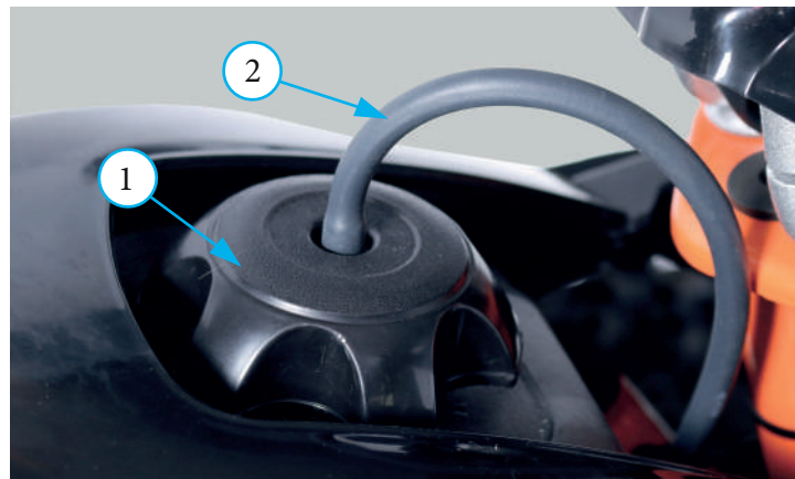
Фото 5.1. Крышка топливного бака - 1; трубка сапуна – 2
