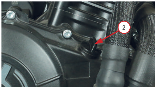
Фото 5.4. 2 – Пробка горловины для залива масла
