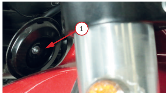
1 – Регулировочный винт электрического звукового сигнала
