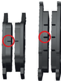
Фото 5.8. Определение износа тормозных колодок
