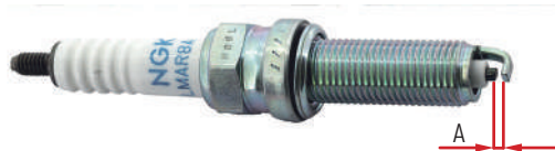
Фото 5.3. Зазор «А» между электродами свечи зажигания
