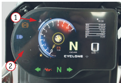
Фото 2.10. Вид приборной панели: 1 – TFT-дисплей (с данными температуры двигателя, количества топлива в баке, температуры внешней среды, текущего времени, показаний тахометра, скорости движения, текущей передачи, заряда аккумуляторной батареи); 2 – сигнальные индикаторы (неисправное состояние ABS, включенный дальний свет, повышенная температура двигателя, неисправность двигателя, указатели поворотов, пониженное давление масла)
