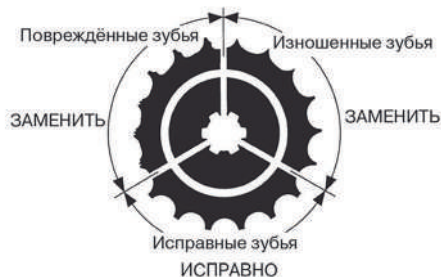
Рисунок 2. Износ звезд
