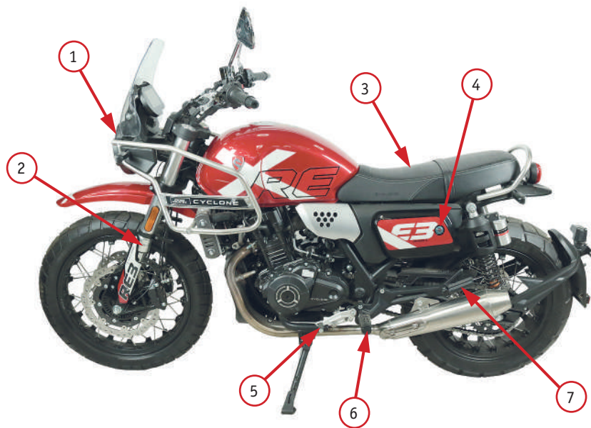
Фото 2.3. Вид слева: 1 – фара; 2 – передний амортизатор; 3 – сиденье на двух человек; 4 – фиксатор сиденья; 5 – рычаг переключения передач; 6 – левая подножка водителя; 7 – левая подножка пассажира
