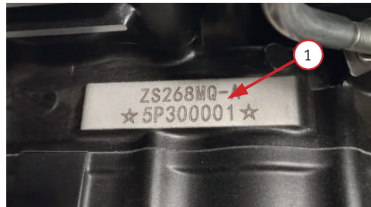
Фото 1.1. Справа на двигателе нанесен серийный номер двигателя – 1
