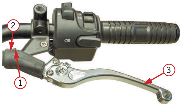
Фото 2.12. Регулировка сцепления: 1 – стопорная гайка; 2 – регулировочный винт; 3 – рычаг сцепления
