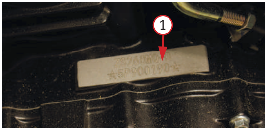
Фото 1.1. Справа на двигателе нанесен серийный номер двигателя - 1
