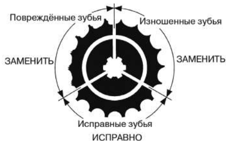
Рисунок 2. Износ звезд
