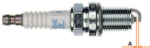
Фото 5.3. Зазор «А» между электродами свечи зажигания
