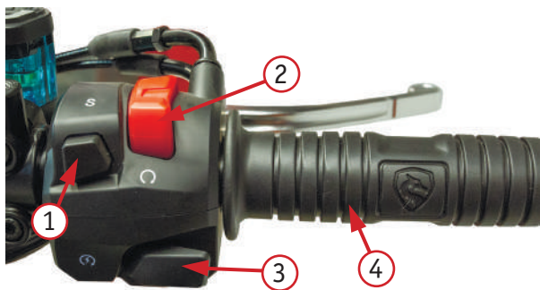
Фото 2.5. Правый комбинированный переключатель: 1 – кнопка настройки панели (аналогична кнопке на левом блоке); 2 - переключатель включения/отключения питания; 3 – электростартер; 4 – ручка газа (акселератора)
