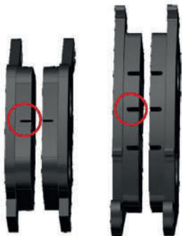
Фото 5.9. Определение износа тормозных колодок
