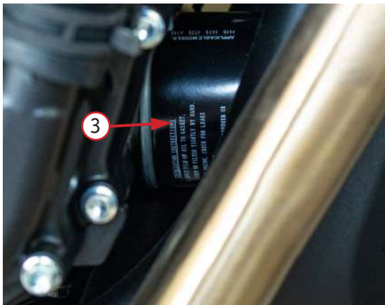
Фото 5.6. Замена масляного фильтра 3
