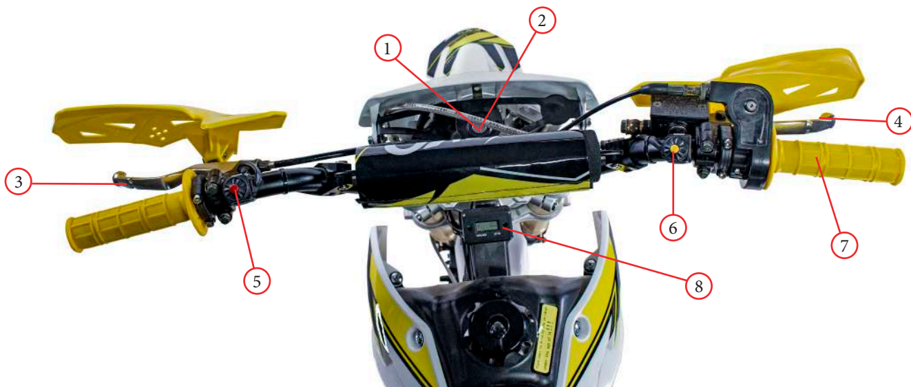
Фото 2.3 Приборы и органы управления: 1 – замок зажигания; 2 – вкл./выкл. фары (не на всех моделях); 3 – рычаг сцепления; 4 – рычаг переднего тормоза; 5 – кнопка выключения двигателя; 6 – кнопка стартера; 7 – рукоятка акселератора; 8 – приборная панель/счетчик моточасов.
