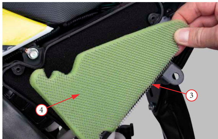
Фото 5.7. Обслуживание воздушного фильтра закрытого типа.
