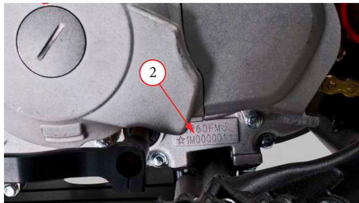
Фото 1.4. Место расположения серийного номера двигателя - 2.
