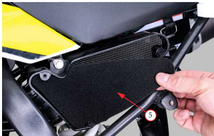
Фото 5.7. Обслуживание воздушного фильтра закрытого типа.
