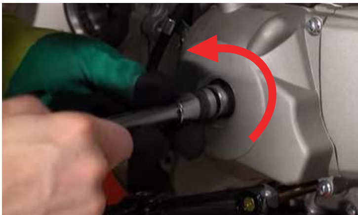
Фото 5.34. Направление вращения маховика коленчатого вала.
