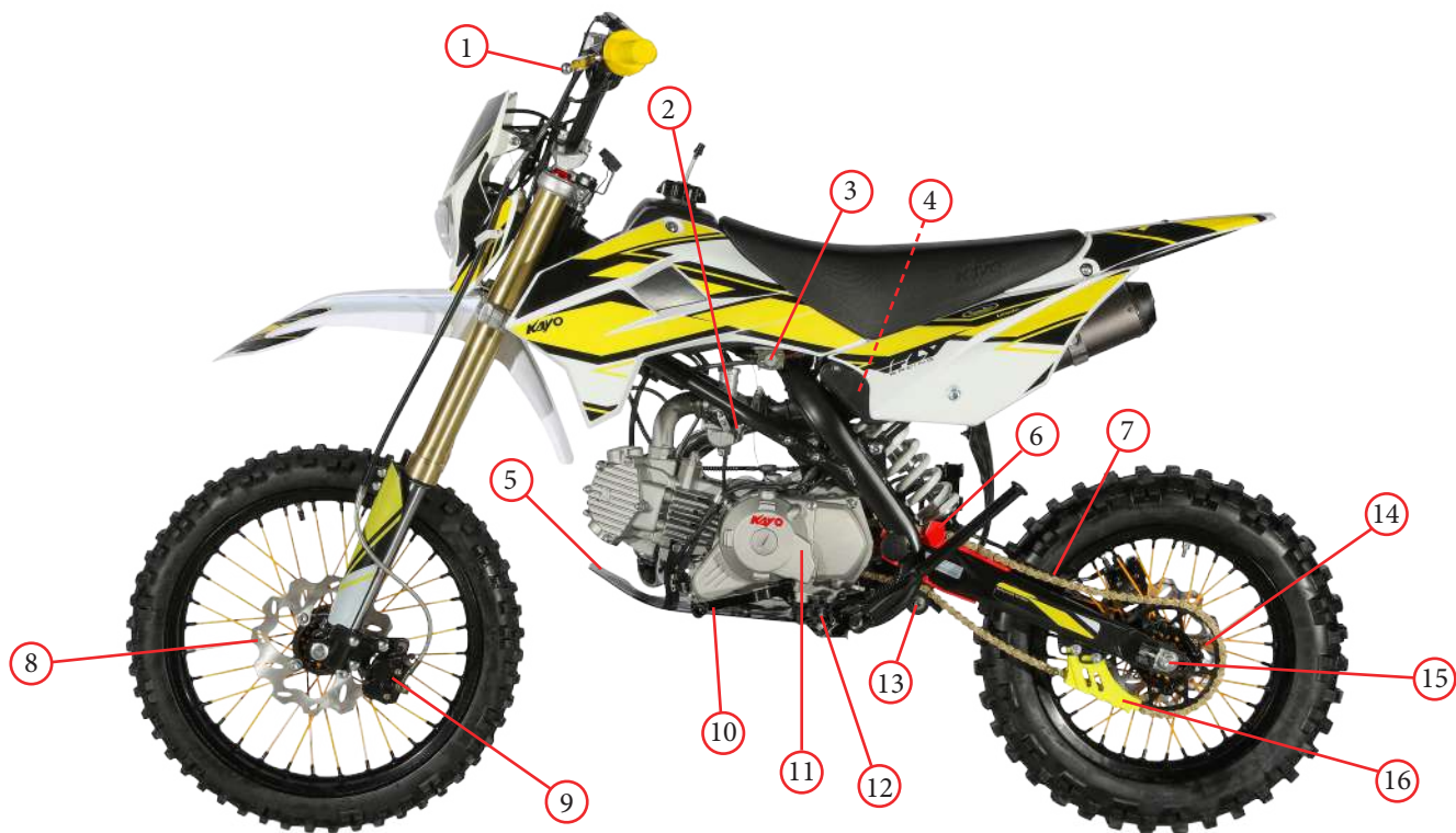
Фото 2.1 Левая сторона питбайка: 1 – рычаг сцепления; 2 – карбюратор; 3 – топливный кран; 4 – воздушный фильтр; 5 – защита двигателя; 6 – слайдер-уловитель цепи; 7 – приводная цепь; 8 – передний тормозной диск; 9 – передний тормозной суппорт; 10 – рычаг переключения передач; 11 – крышка картера левая; 12 – левая подножка водителя; 13 – ролик натяжения цепи; 14 – ведомая звезда; 15 – задняя ось/ натяжитель цепи; 16 – уловитель цепи.
