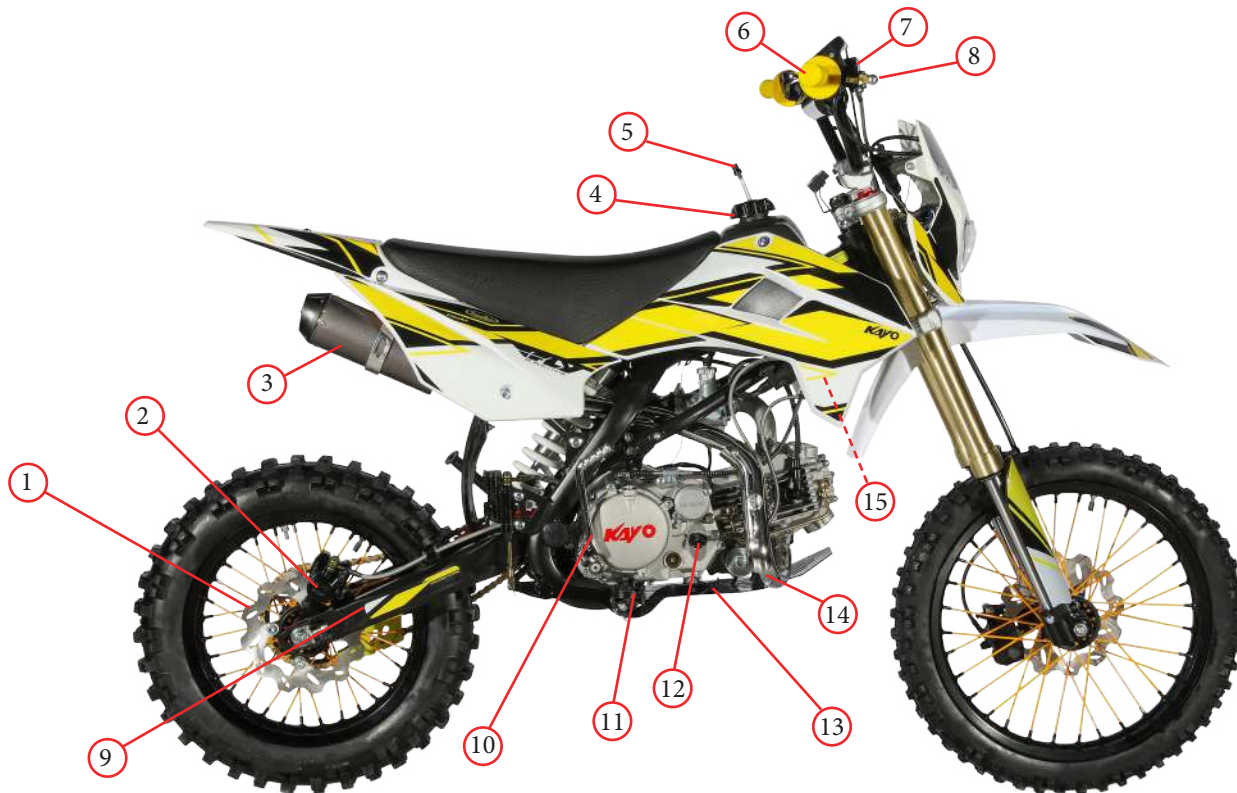
Фото 2.2 Правая сторона питбайка: 1 – задний тормозной диск; 2 – задний тормозной суппорт; 3 – глушитель; 4 – крышка топливного бака; 5 – клапан крышки топливного бака; 6 – рукоятка акселератора; 7 – тормозная машинка переднего тормоза; 8 – рычаг переднего тормоза; 9 – маятник, 10 – рычаг кик-стартера; 11 – правая подножка водителя; 12 – крышка маслозаливной горловины; 13 – педаль заднего тормоза; 14 – приемная труба глушителя; 15 – радиатор масляного охлаждения.
