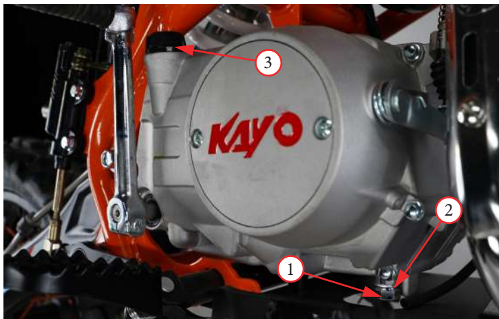
Фото 5.4. Замена масла в двигателях без фильтра.
