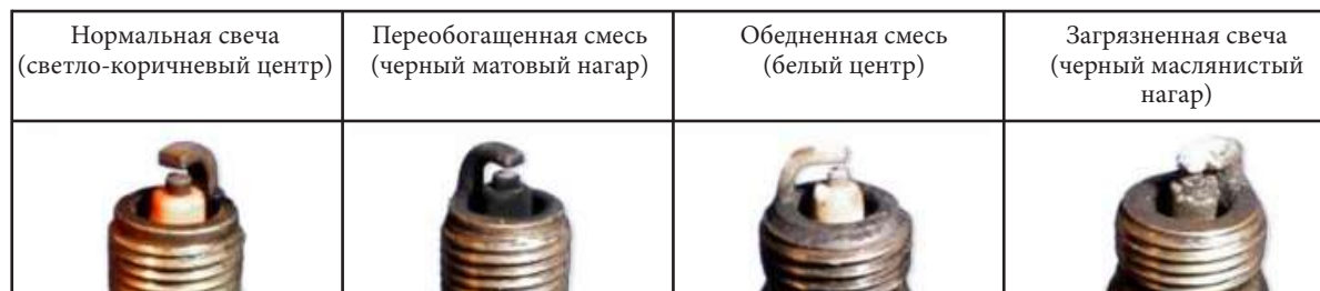
Фото 5.13. Состояния свечи зажигания.
