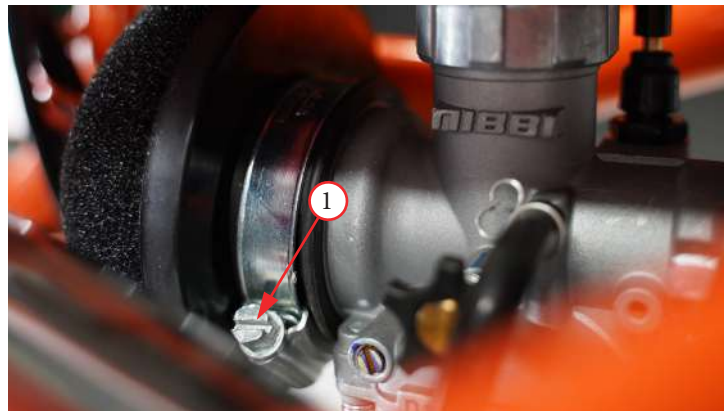
Фото 5.6. Крепление воздушного фильтра.
