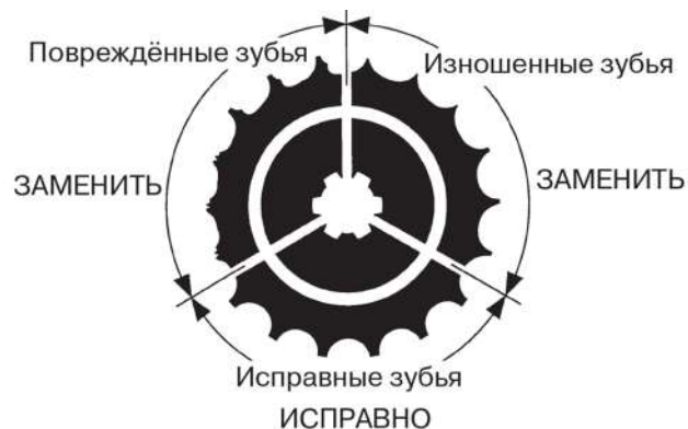
Рисунок 5.24. Вид зубьев звездочки.
