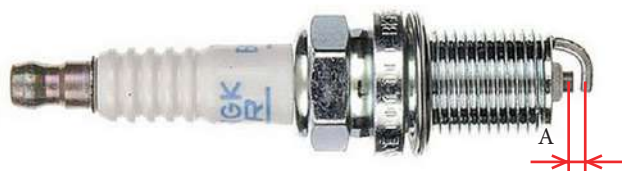
Фото 5.14. Зазор свечи зажигания - А.
