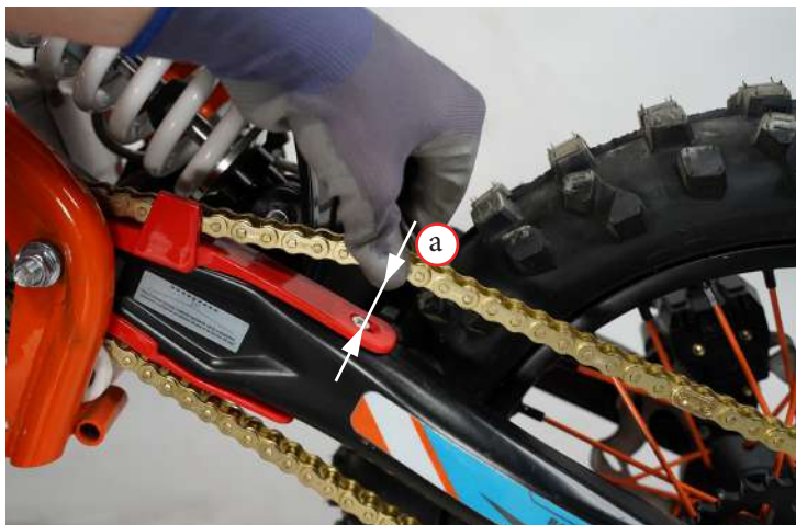
Фото 5.23. Замер провисания цепи.
