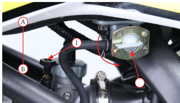
Фото 3.2. Топливный кран - 2; рычаг обогащения/обеднения топливной смеси - 1 (положения: А – обогащение; Б – обеднение).
